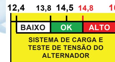
Se o resultado estiver 'BAIXO' significa que o alternador não está gerando carga suficiente para a bateria, já, se o resultado for 'ALTO' significa que o regulador de tensão não está controlando a corrente e regulando a tensão.
